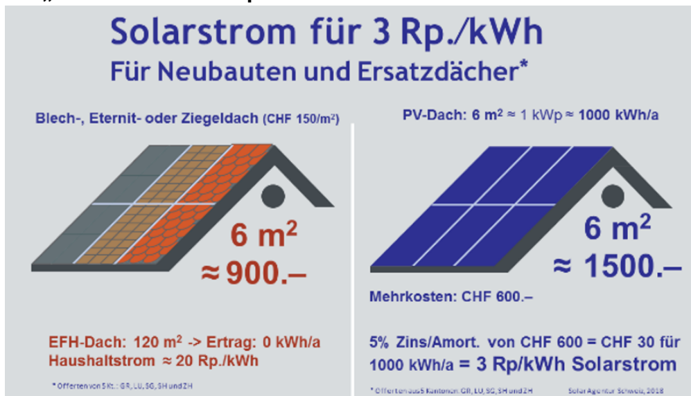
Abb. 26a und 26b: Solarstrom für 3 Rp./kWh – Tendenz fallend. *David Gautschi, Leiter Erneuerbare Energien der Aargauer Elektrizitätswerke (AEW). Die Solarstrompreise liegen bei korrekter Berechnung gemäss Bundesgericht bei 3 bis 7 Rp./kWh, wie obige Abbildungen bestätigen (vgl. BGE 132 I 157 und Schweizer Solarpreis 2020, S. 93).
