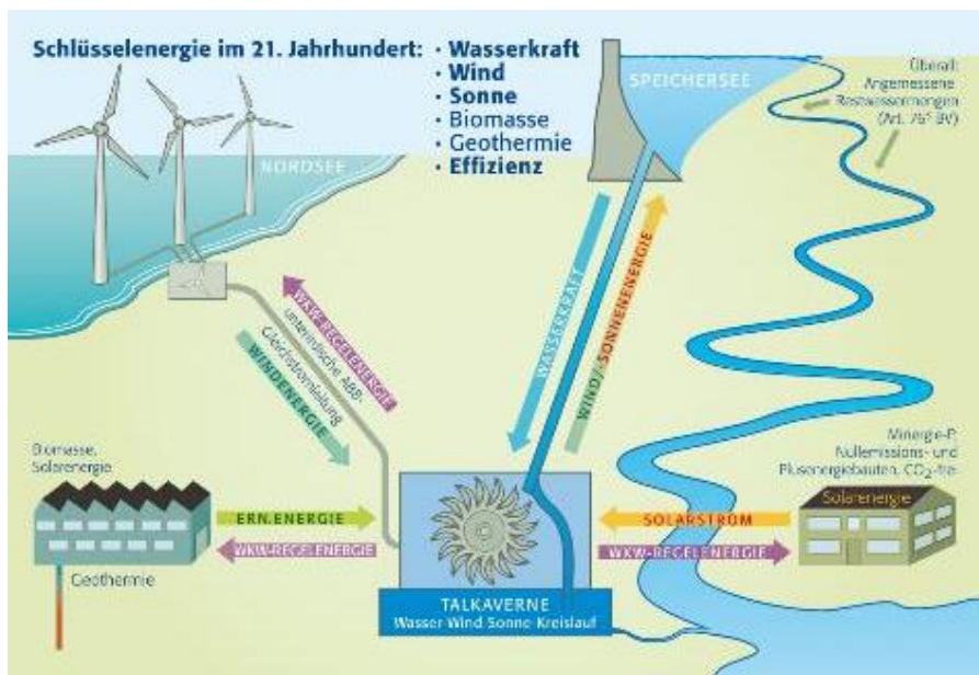
Abb. 12: Schweizer Wasserkraft als Regelenenergielieferant und Netz-Stabilisator für Mitteleuropa dank Pumpspeicherkraftwerken. Auch der Bundesrat sprach sich für PSKW aus (IP 10.3269).
